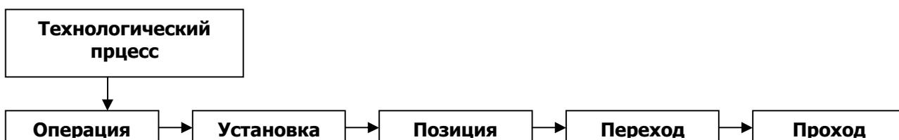
Часть технологической операции, выполняемая при неизменном закреплении обрабатываемых заготовок или собираемой сборочной единицы, называют **установкой**.
